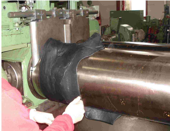
Obr. 23 Příprava směsi na dvouválci
