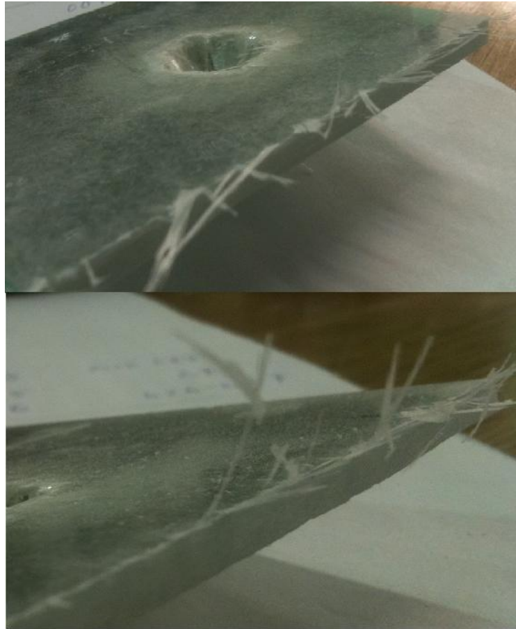
Obr. 42 Obrobený povrch frézou č. 3 a 4, materiál A
