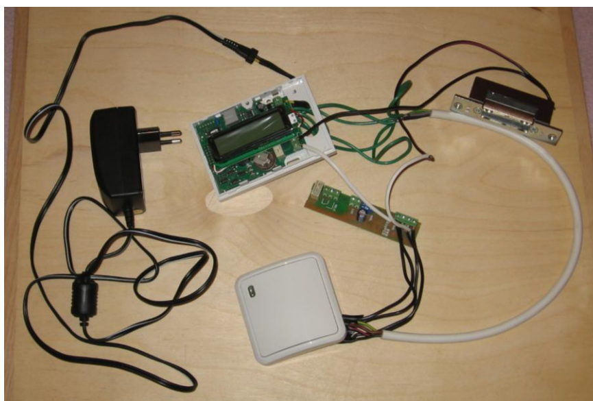
Obr. 24: testování podomácku provedeného zapojení systému RP-02
