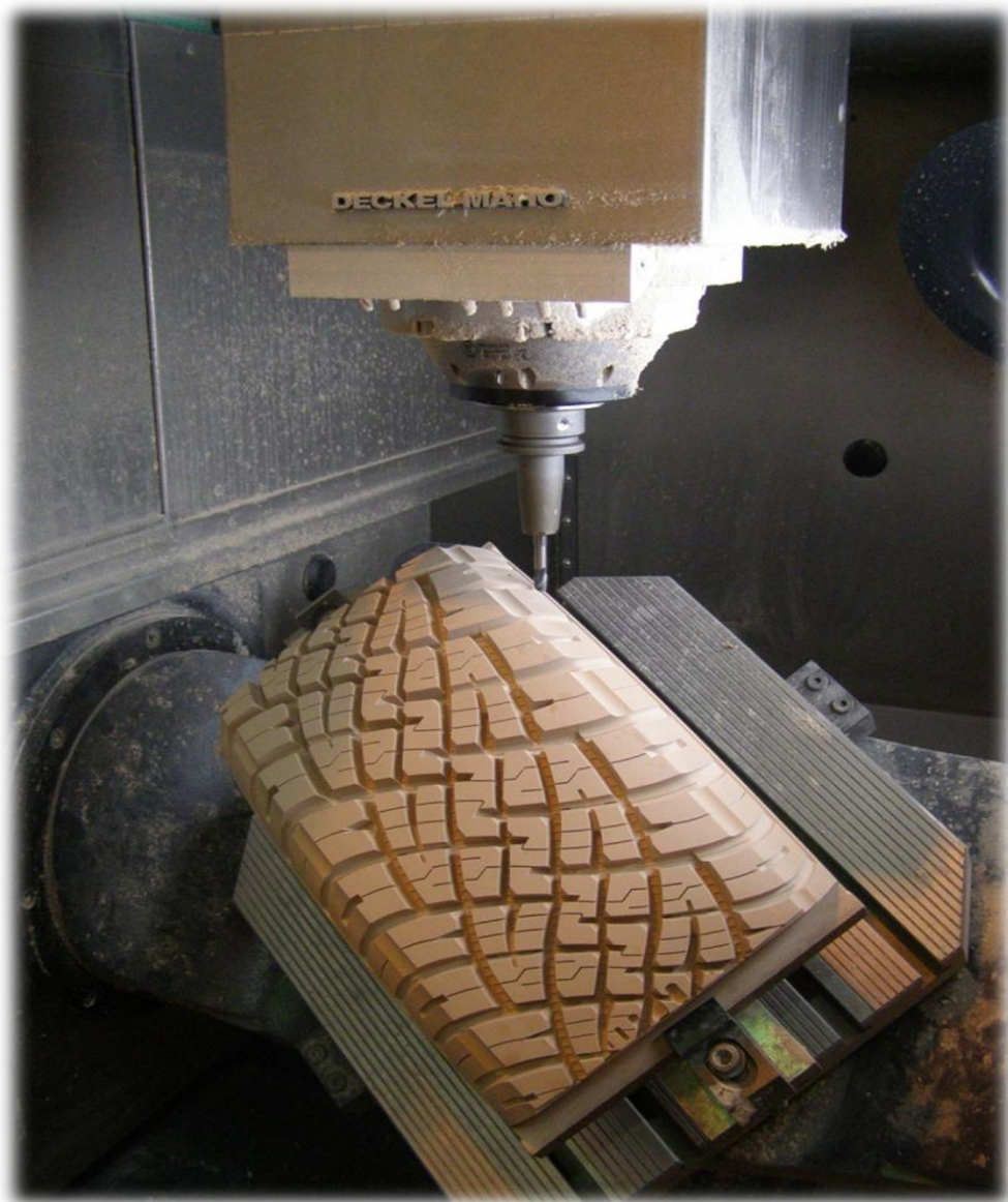
Obrázek 11 Frézování modelu na víceosé frézce [8]
