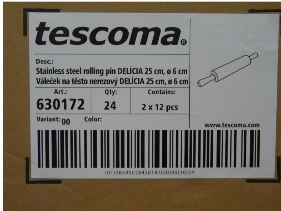
Obr. 9. Čárový kód pro identifikaci přepravního balení EAN/UCC [23]
