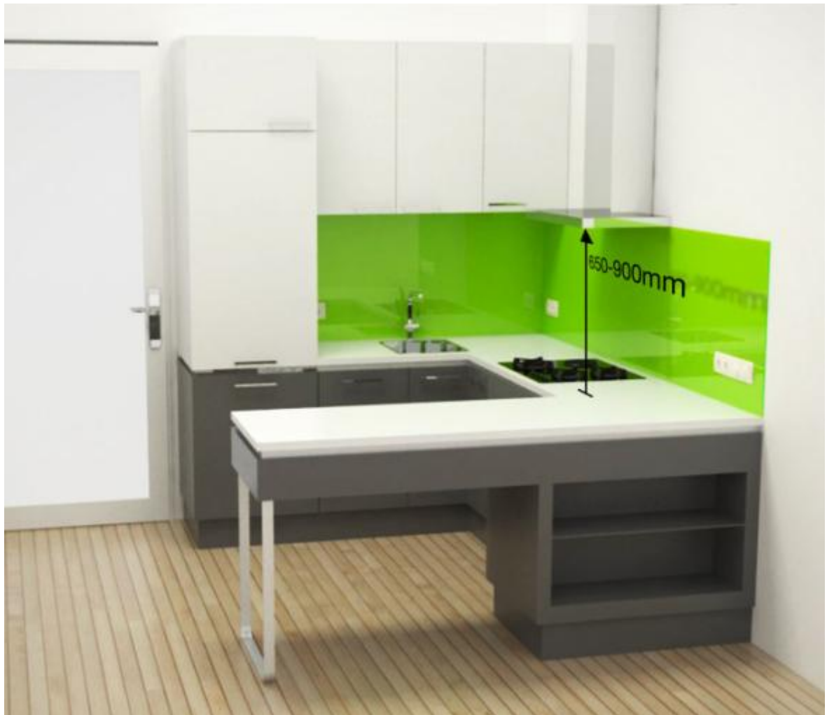
Obr. 4 Ideální výška usazení digestoře
