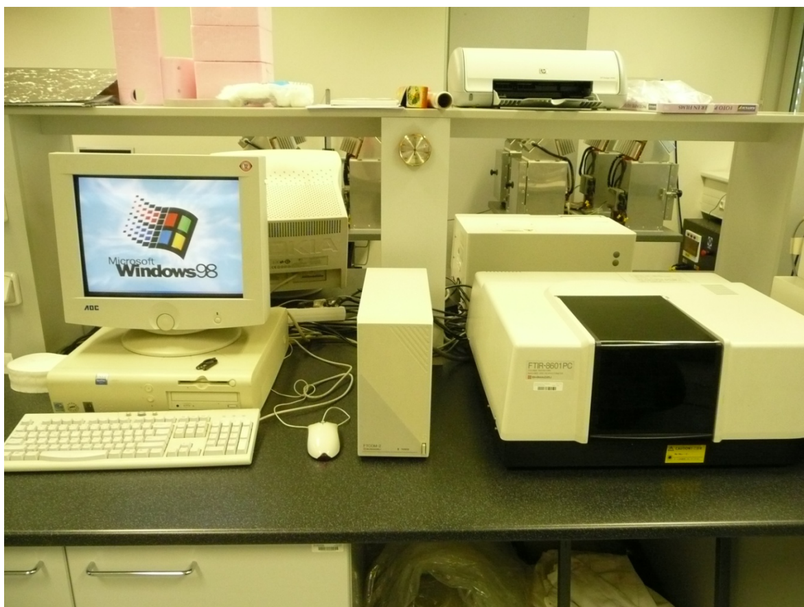
Obr. 22. Spektrometer FTIR – 8601 PC od spoločnosti Shimadzu
