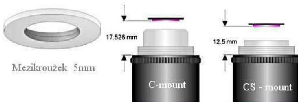
Obr. 16. Objektivy s uchycením C a CS. [10]
