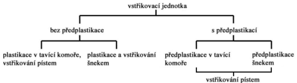
Obr. 6 Rozdělení vstřikovacích jednotek [4]
