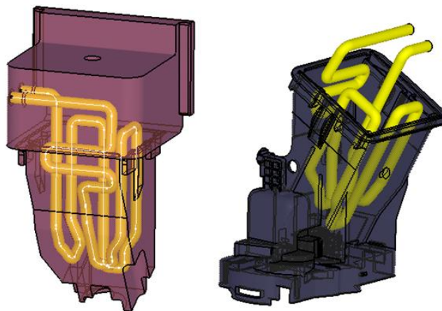
Obr. 77 Temperace horní tvarové vložky
