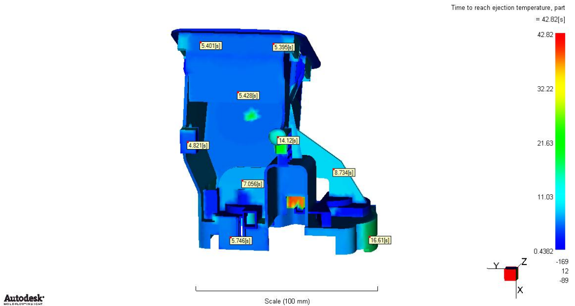
Obr. 107 Čas potřebný k dosažení vyhazovací teploty (1.varianta temperace)
