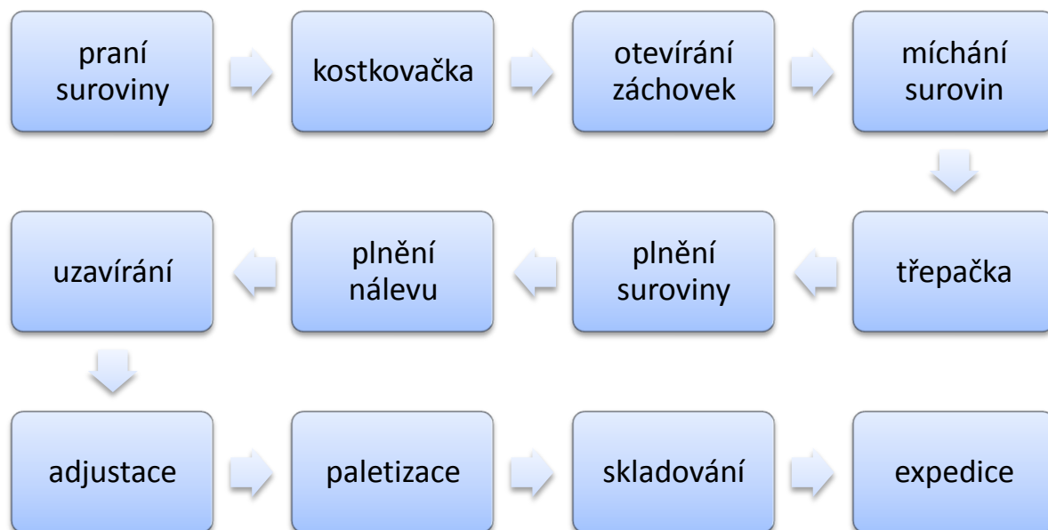
Obr. č. 11 Proudový diagram technologického postupu zpracování zeleninové směsi
