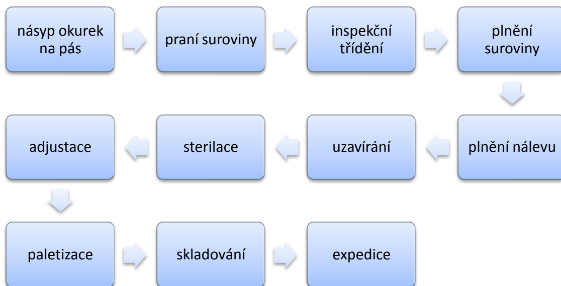
Obr. č. 7 Proudový diagram technologického postupu zpracování okurek
