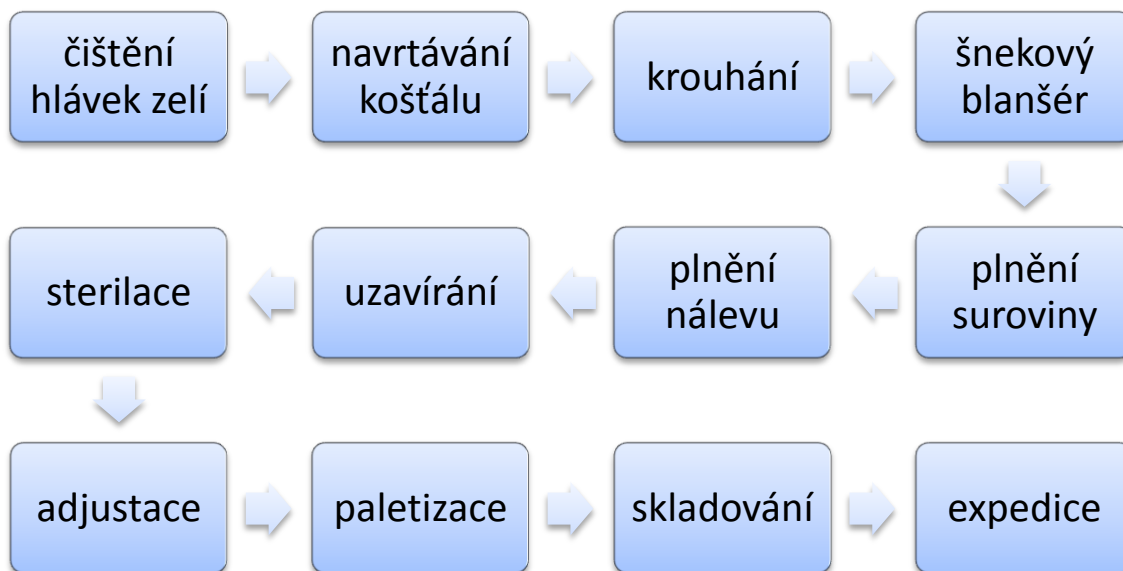
Obr. č. 9 Proudový diagram technologického postupu zpracování bílého zelí
