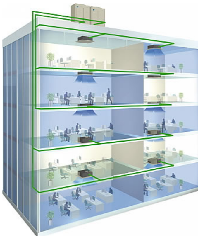
Obr. 23. Ukážka prevedenia VRV systému Daikin
