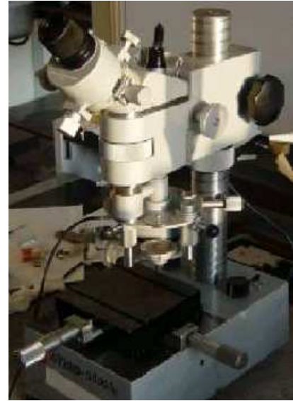
Obr. 17. Schéma a pohled na mikrotvrdoměr Durimet
