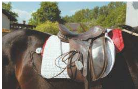
Obrázek 40 Osedlaný kůň s pliance®-s podložkou přichystanou k měření. Zde je vidět, že pliance®-s podložka sahá pouze do poloviny výšky stranic sedla. [10]
