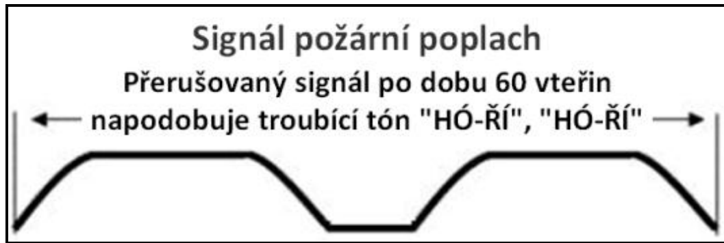
Obrázek 5 Signál požární poplach [Zdroj:vlastní]
