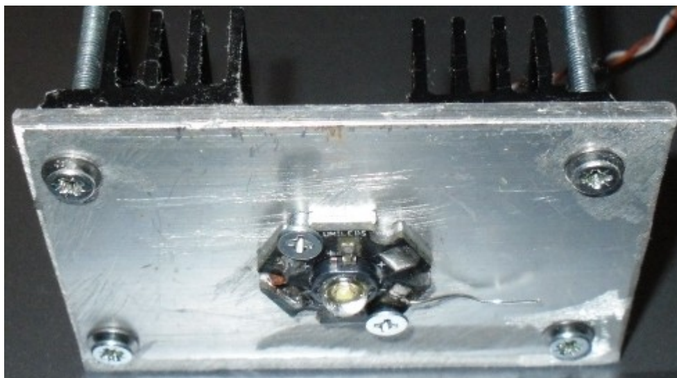
Obr 64: Výkonová LED na Alu chladiči
