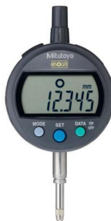
Obr. 18. Digitální úchylkoměr Mitutoyo
