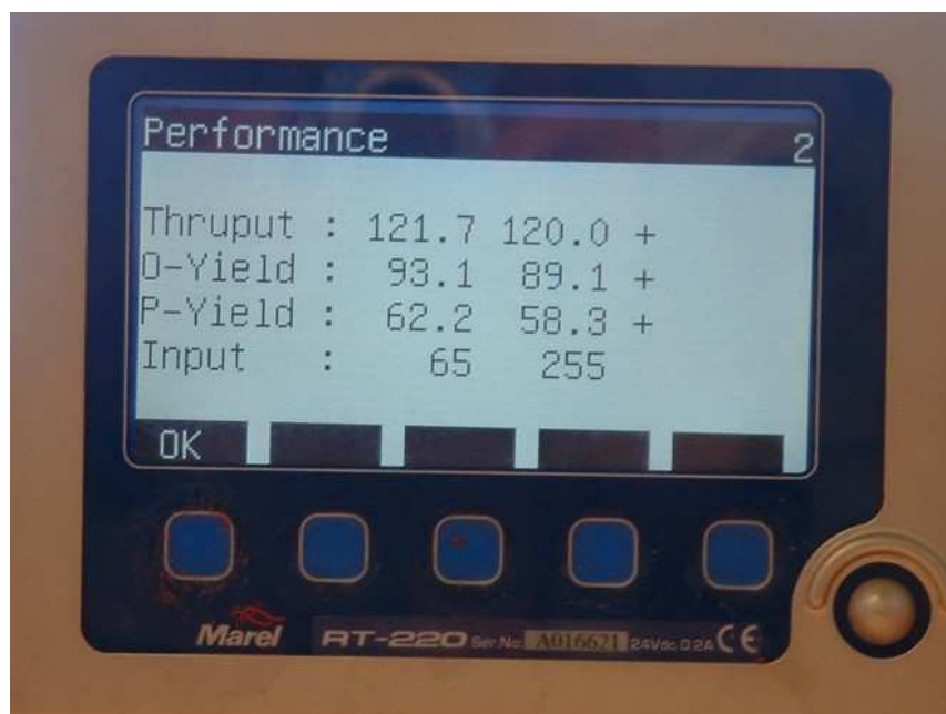
Obrázek č. 9 Zobrazovací terminál RT-220 [42]
