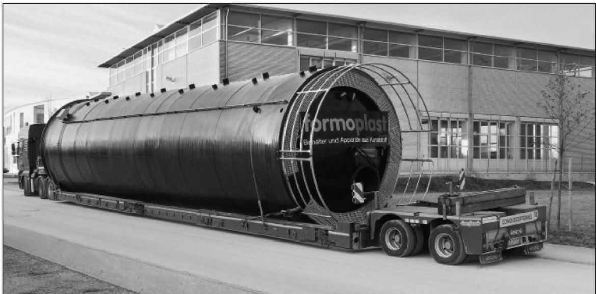
Obr. 3 Příklad nádoby vyráběné spirálním navíjením
