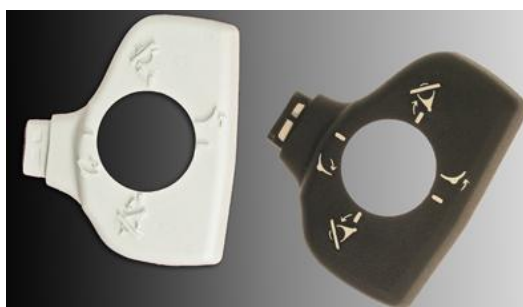
Obr. 19.: Získání výrobku více-násobným vstřikováním [14]
