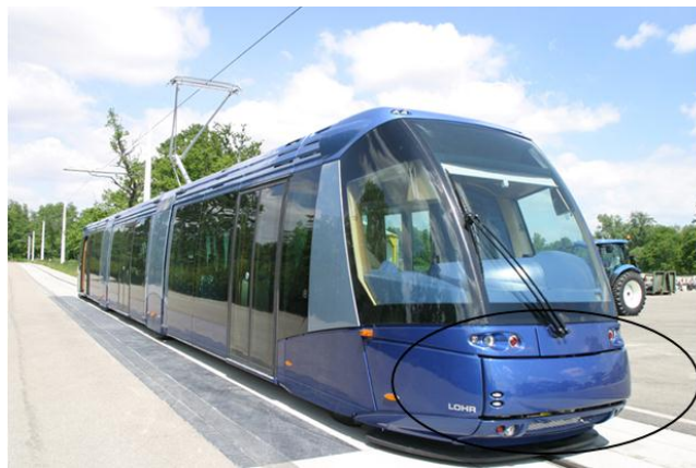
Obr. 21 Lepený nárazník tramvaje [13]
