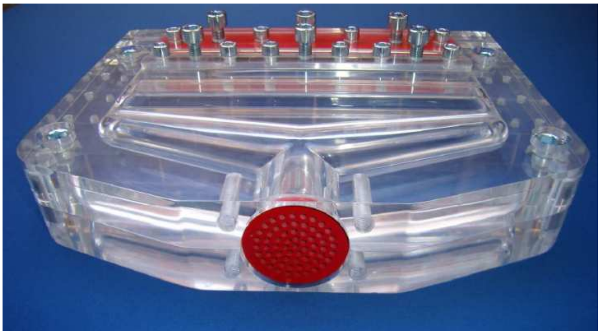
Obr. 46 Vyrobený výukový model široko-štěrbinové vytlačovací hlavy [8]
