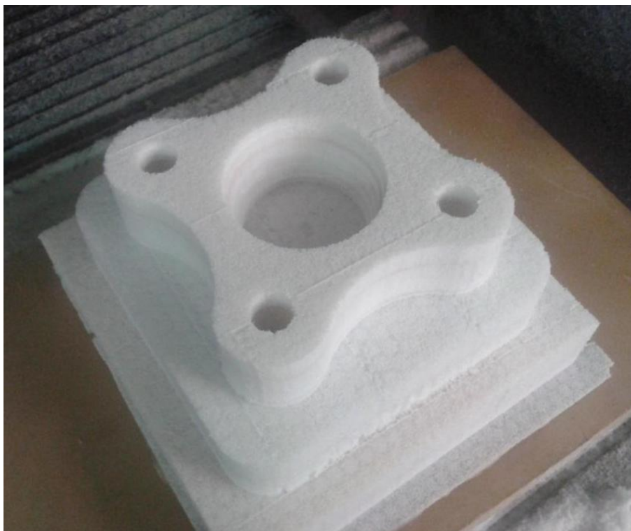
Obr. 38. Obrobek před dokončením vnitřního zkosení díry.
