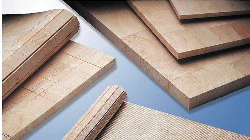
Obr. 22. Tvarované desky z balzy. [18]
