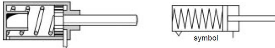
Obr. 10. Jednočinný pneumatický válec s pístnicí v klidové poloze vysunutou [2]
