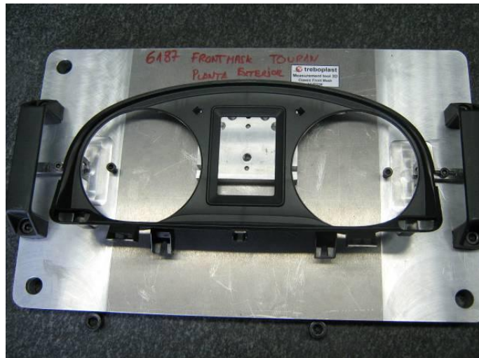
Obr. 7 Touran Front mask : Měřicí základny jsou stanoveny na výrobku formou RPS systému
