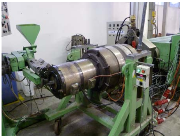
Obr. 9 Přímá vytlačovací hlava na trubky (vlastní zdroj)
