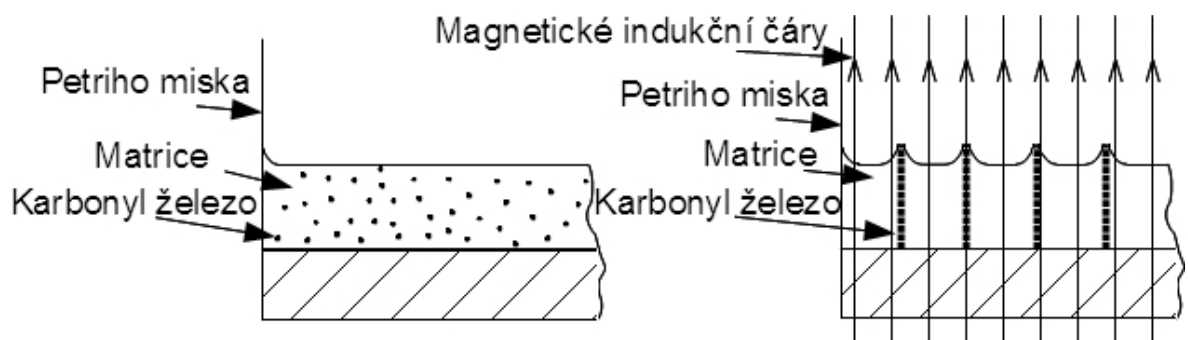
Obr. 19. Uspořádání částic karbonyl železa v silikonové matrici. (vlevo) uspořádání bez přítomnosti magnetického pole, (vpravo) uspořádání v přítomnosti magnetického pole.
