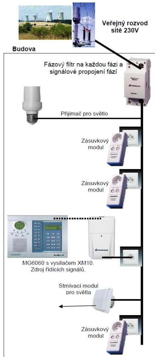
Obr. 23: Struktura systému domácí automatizace X10 [14]
