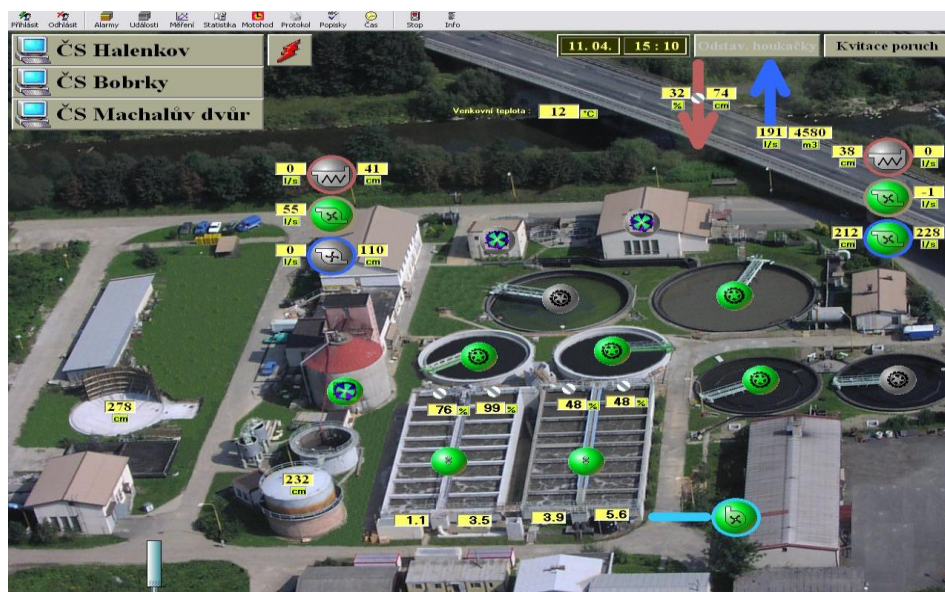
Obr. 4. Přehledový snímek z ovládacího počítače ve velínu ČOV
