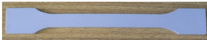
Obr. 29. Skúšobné teleso pre ťahovú skúšku.
