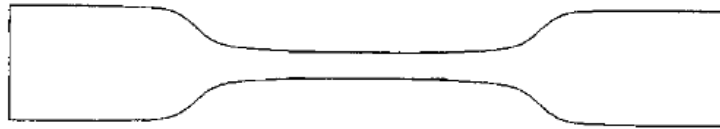
Obr. 16. Typický tvar skúšobného telesa pre skúšku ťahom. [1]
