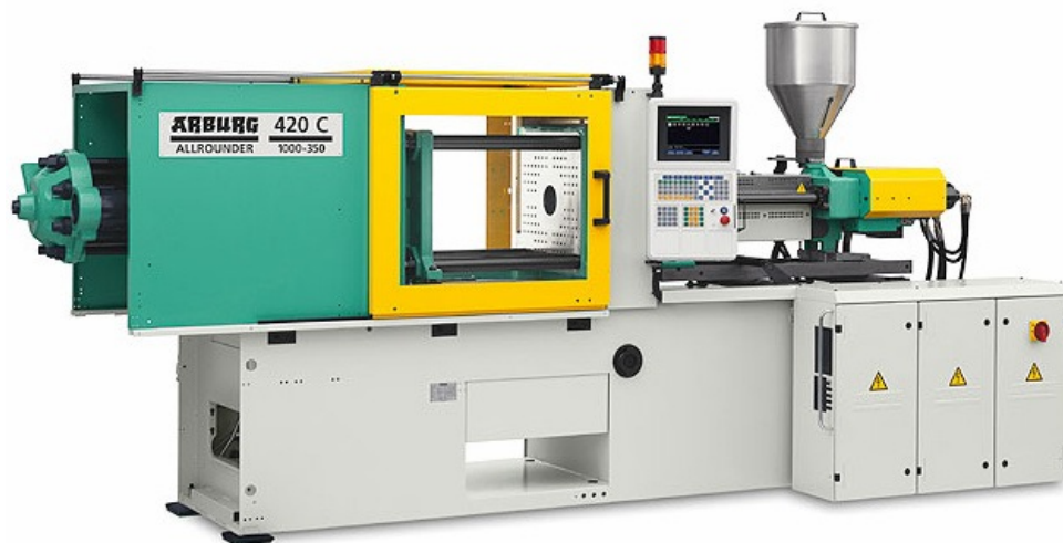
Obr. 24. Vstrekovací stroj Arburg Allrounder.
