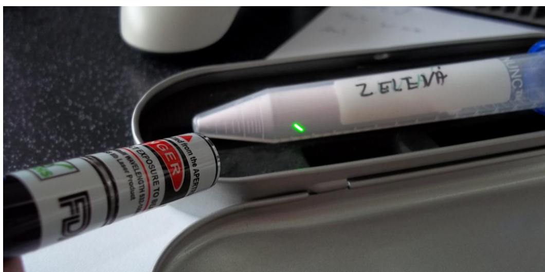
Obr. 15 Ozáření zeleného luminiscenčního prášku laserem
