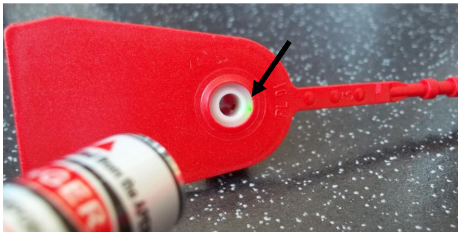
Obr. 36 Plastová bezpečnostní plomba s příměsí BOP
