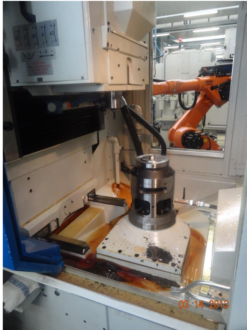
Obr. 21 - Nahromadění špony z důvodu nedostatečného čištění stroje [vlastní zpracování]
