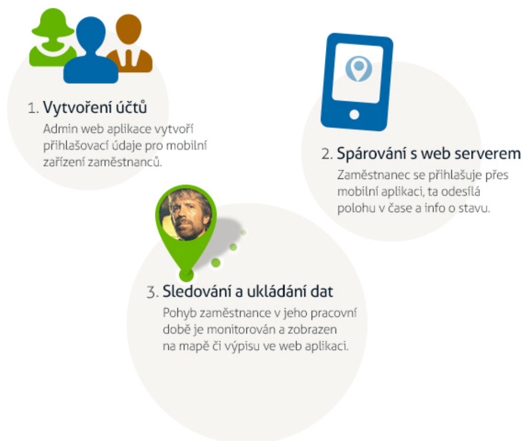
Obr. 1: Zjednodušený princip fungování systému LocMonitor.
