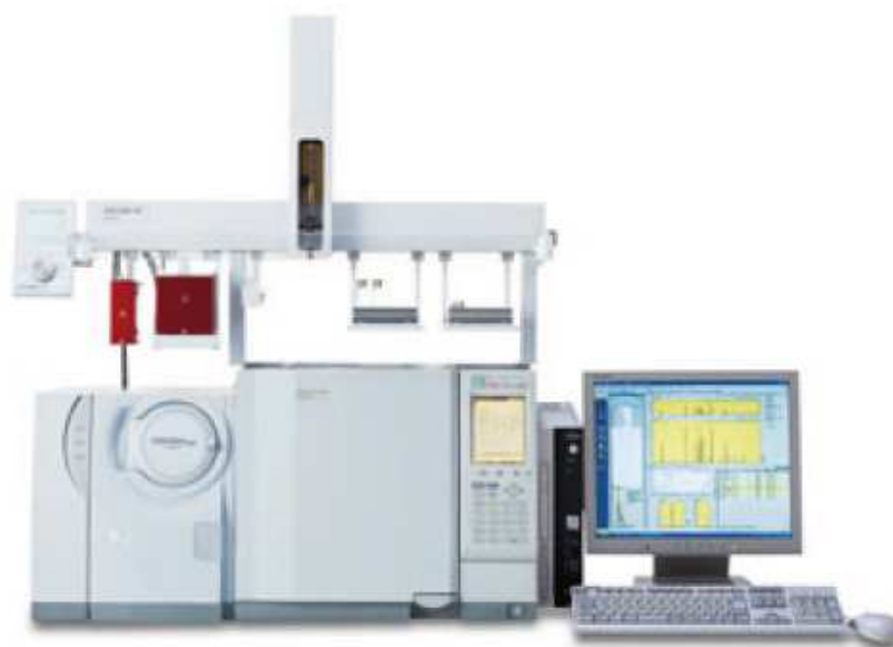
Obr. 13 Měřicí sestava – CG, CGMS, autosampler
