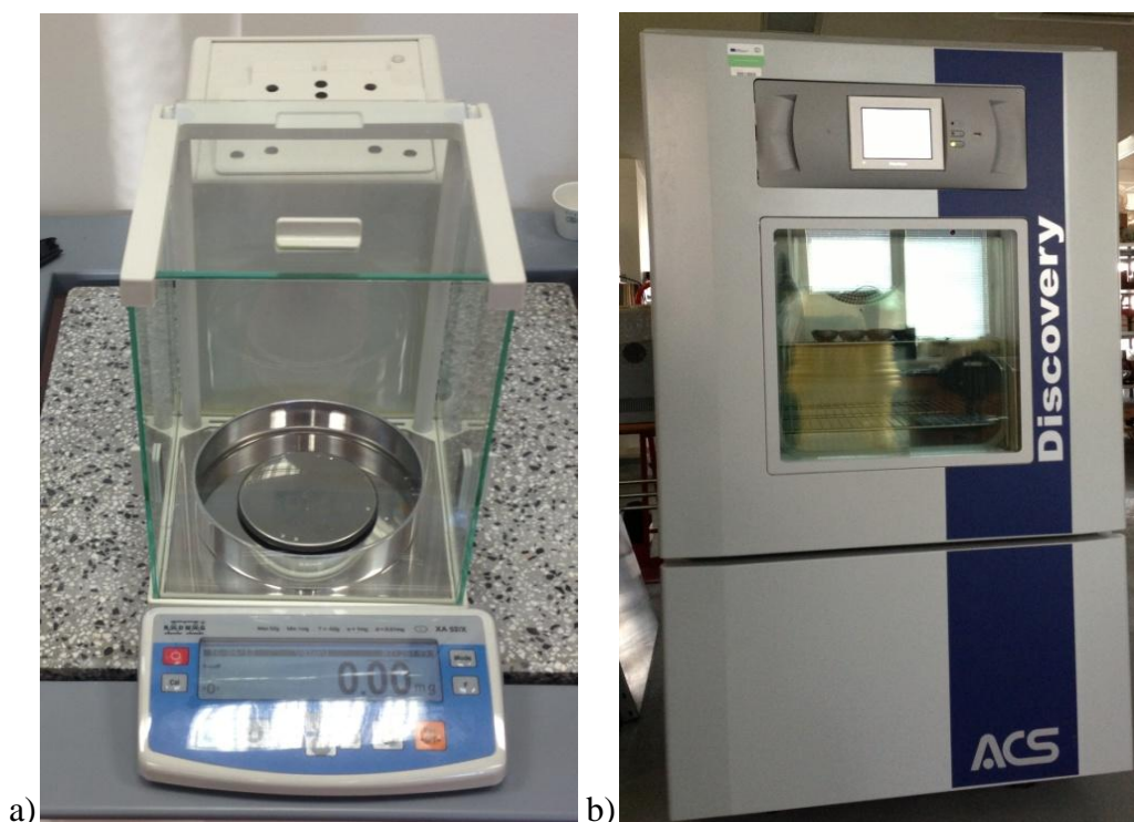
Obrázek 11: a) Váhy pro vážení přírůstku hmotnosti b) Klimatizační komora.
