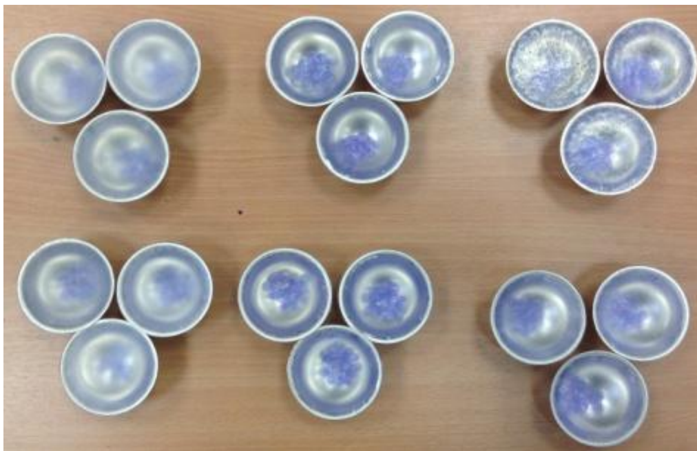
Obrázek 10: Vzorčky polymerů na misce s desikantem připravené k vážení - CE, RV, PSY, ŠN, PVA, ŠR (kolmý pohled).
