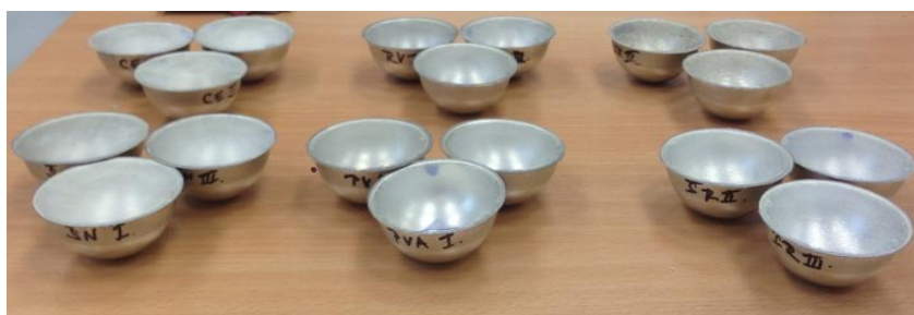
Obrázek 9: Vzorky polymerů na misce s desikantem připravené k vážení (boční pohled).
