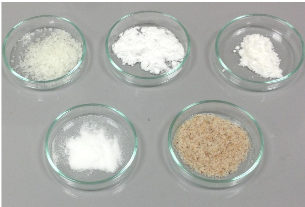
Obrázek 2: Suroviny a přísady - polyvinylalkohol, škrob, \alpha Cellulose, prebiotická vláknina a psyllium.
