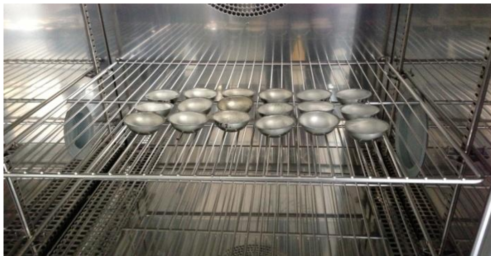
Obrázek 12: Vzorke polymerů uložené v klimatizační komoře.
