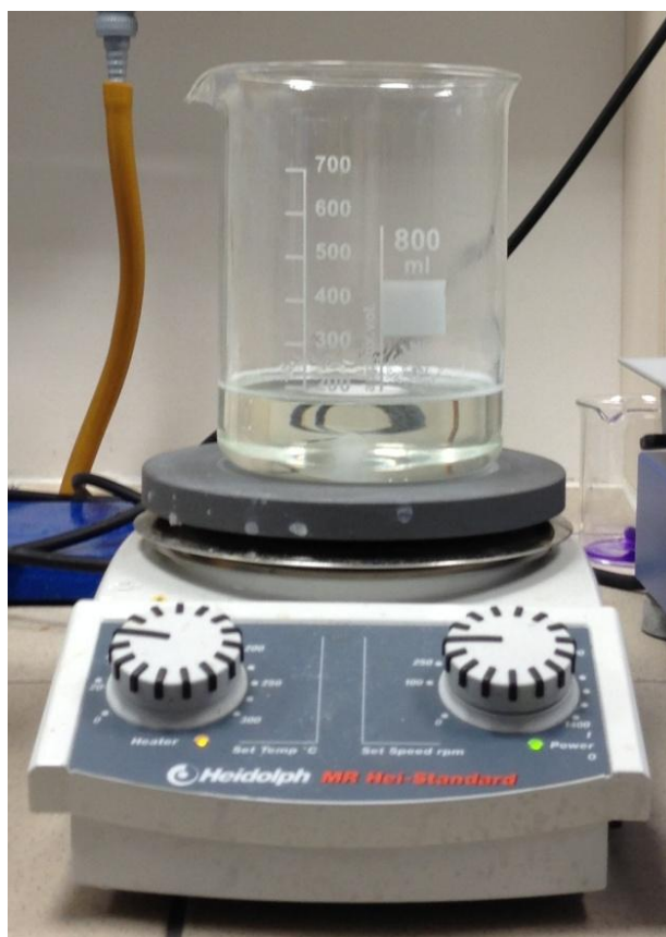
Obrázek 3: Míchání zásobního roztoku PVA.
