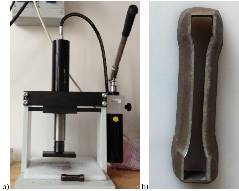
Obrázek 6: a) Vysekávací stolní lis b) Vysekávací matrice zkušebního tělíška.
