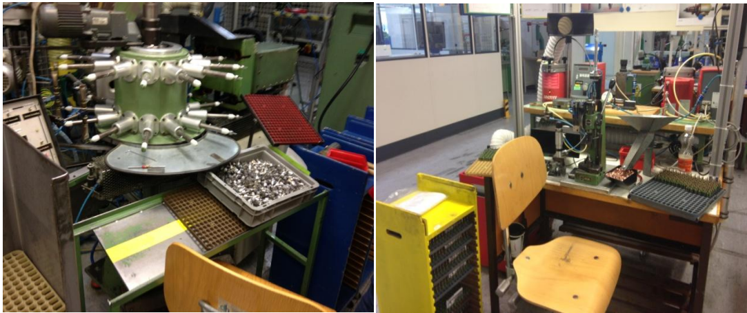
Obr. 19 Sintrování kotev (vlevo) a nalisování a lepení kolektorů (vpravo) (Vlastní zpracování)
