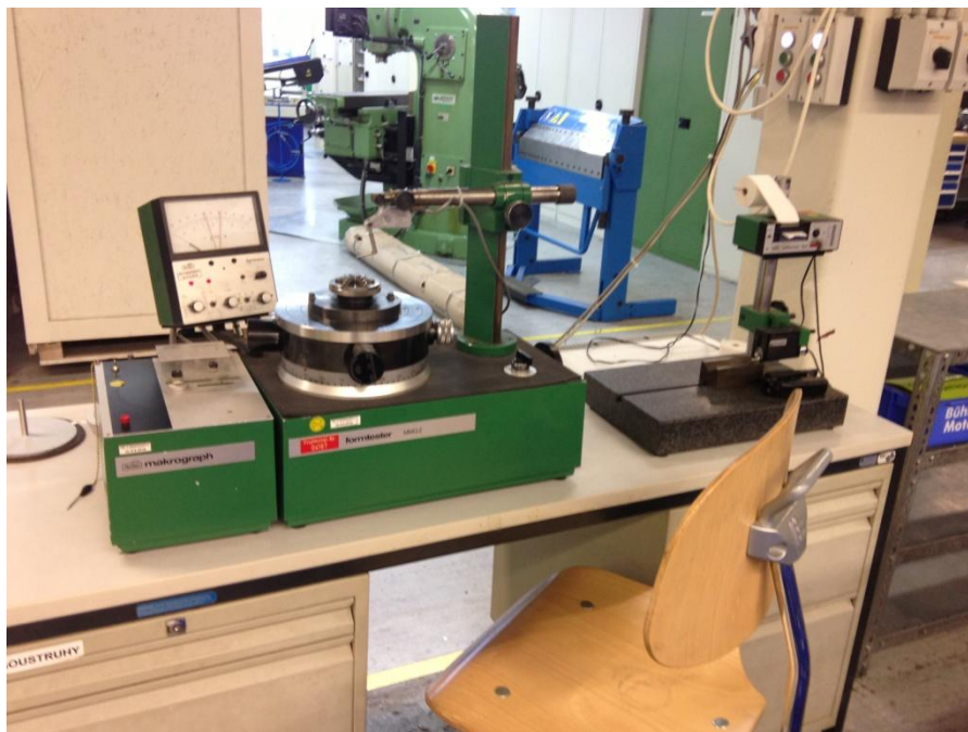
Obr. 25 Měřicí stanice pro měření ovality a drsnosti komutátoru (Vlastní zpracování)
