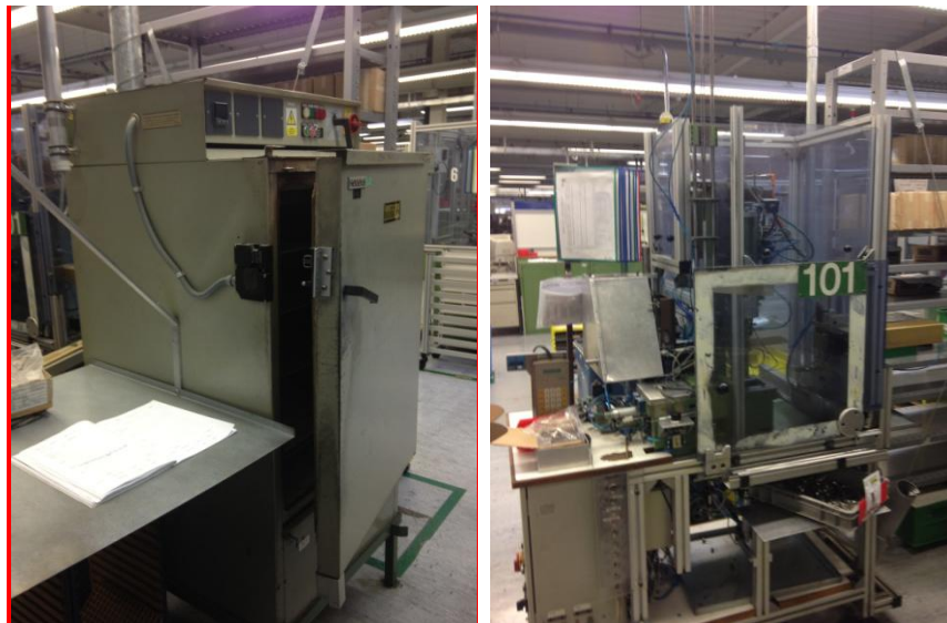
Obr. 20 Vytvrzovací pec (vlevo) a paketovací poloautomat (vpravo) (Vlastní zpracování)
