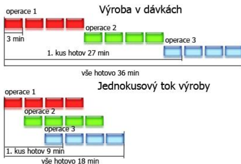
Obr. 10 Schéma výroby v dávkách versus One Piece Flow (Volko, © 2009a)
