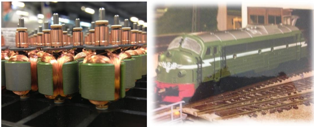
Obr. 18 Hotová kotva a příklad využití hotového elektromotoru (Vlastní zpracování)
