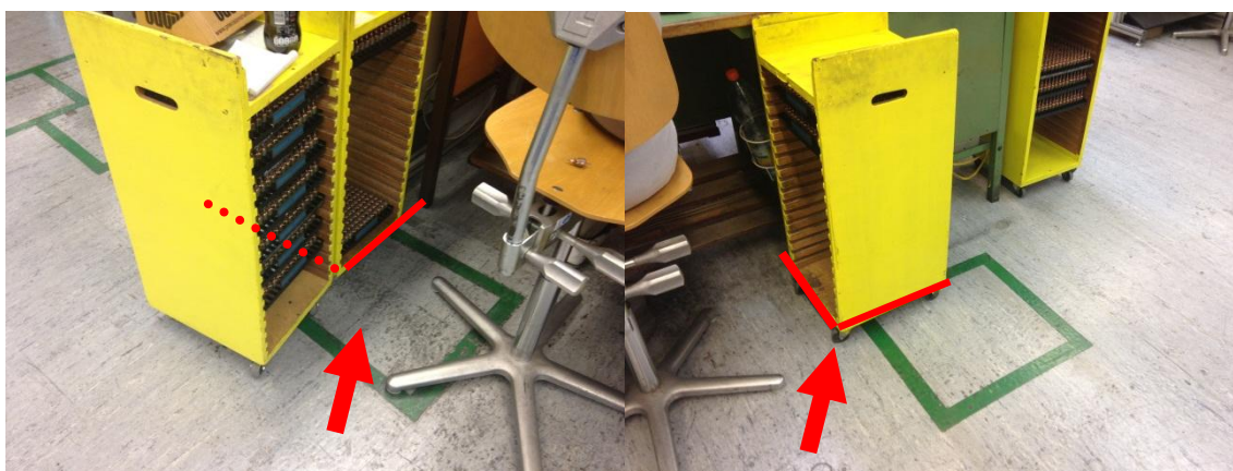
Obr. 32 Změna standardu umístění manipulačního vozíku (Vlastní zpracování)
