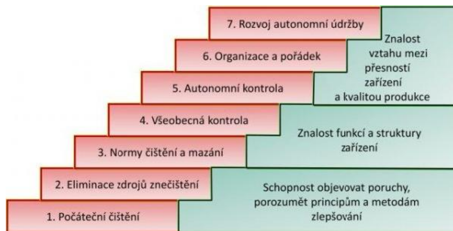
Obr. 2 Proces zavádění autonomní údržby[17]
