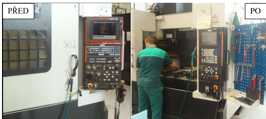
Obr. 24 Umístění nářadí na pracovišti- stroj [Vlastní zpracování]
