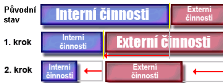
Obr. 3 Schéma principu fungování metody SMED [12]
