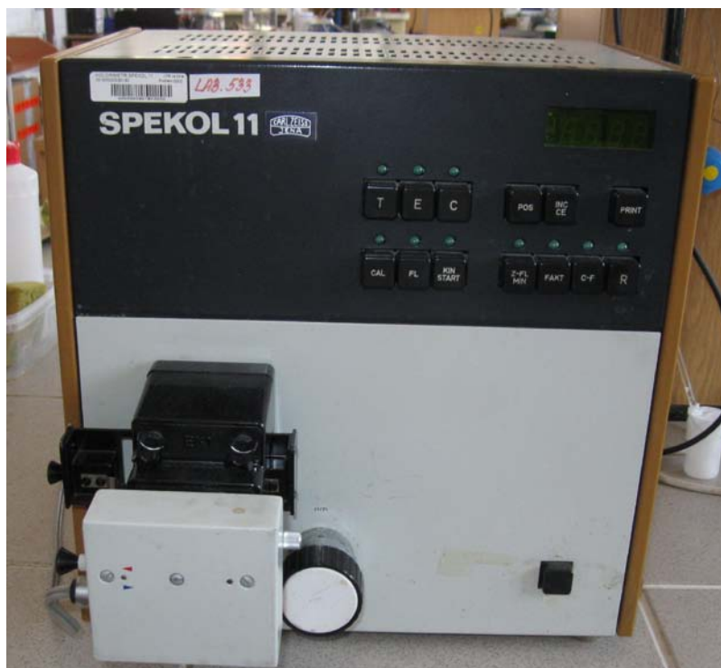
Obr. č. 12 - Přístroj pro měření absorbance roztoků
