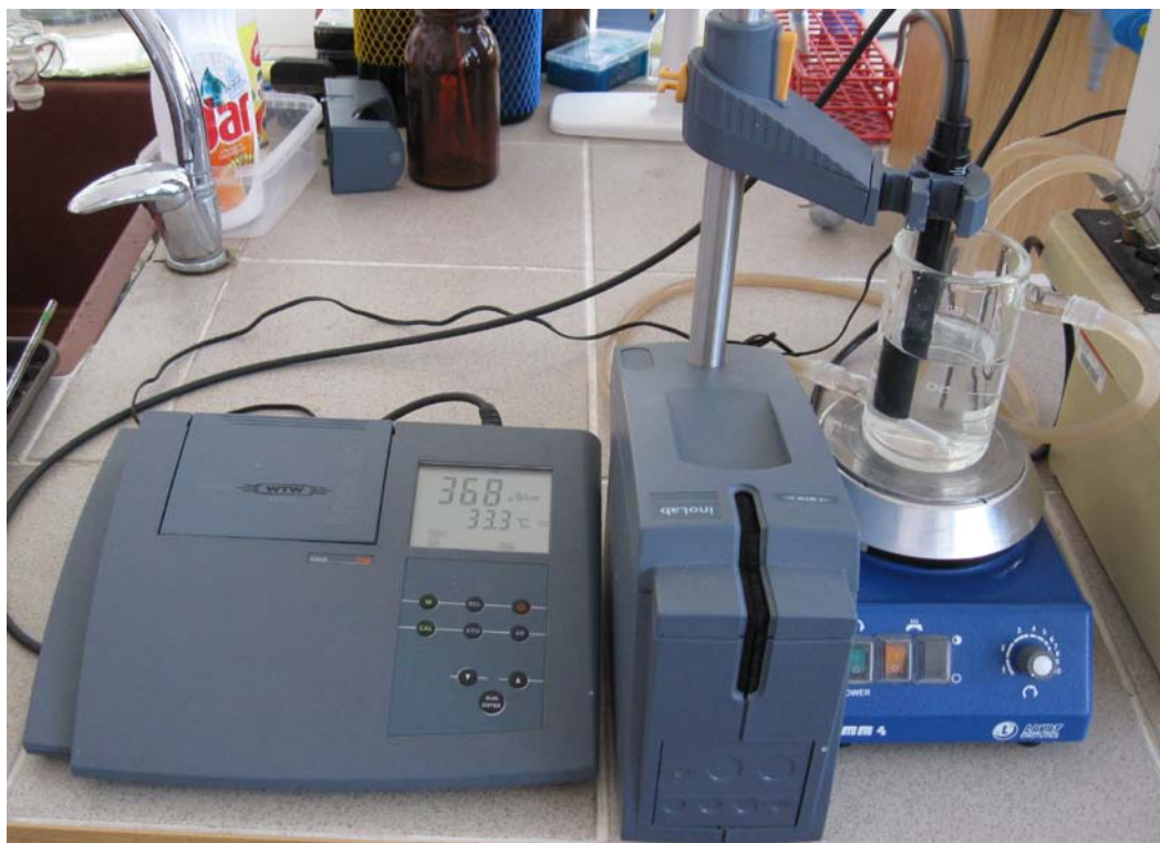
Obr. č. 14 - Zařízení pro stanovení vodivosti roztoků
