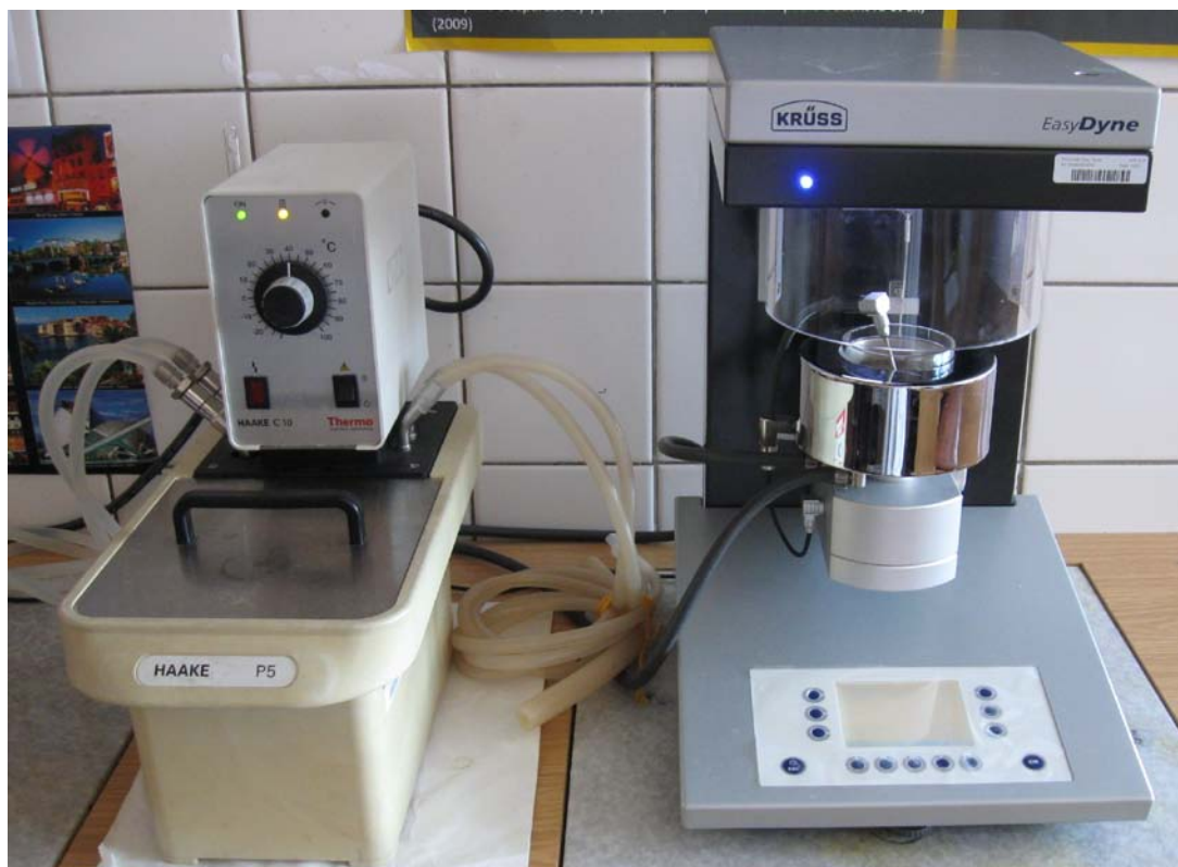
Obr. č. 13 - Sestava pro měření povrchového napětí
