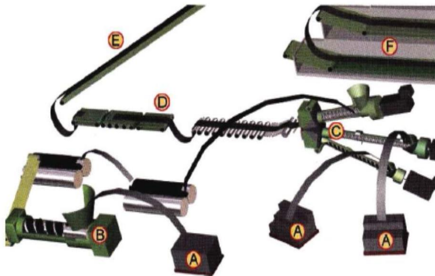
Obr. 28. Linka pre vytlačovanie združených profilov (A – palety zmesi, B – extruder, C – združený extruder, D – odťahový dopravník s úsekovou váhou a značením, E – šikmý dopravník, F – etážová chladička s vodou [3])
