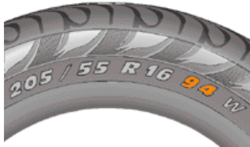
Obr.9. Ukážka vyobrazenia indexu na bočnici pneumatiky [6]
