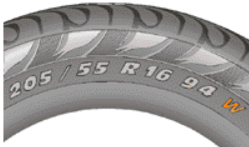
Obr.10. Ukážka vyobrazenia indexu na bočnici pneumatiky [6]
