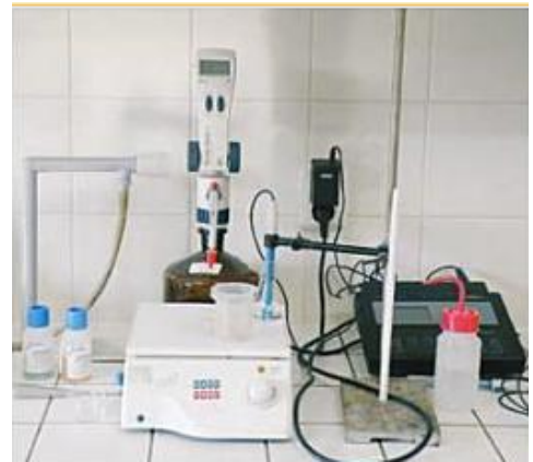
Obr. 19 – Sestava pro stanovení pH a titrovatelných kyselin [13]
