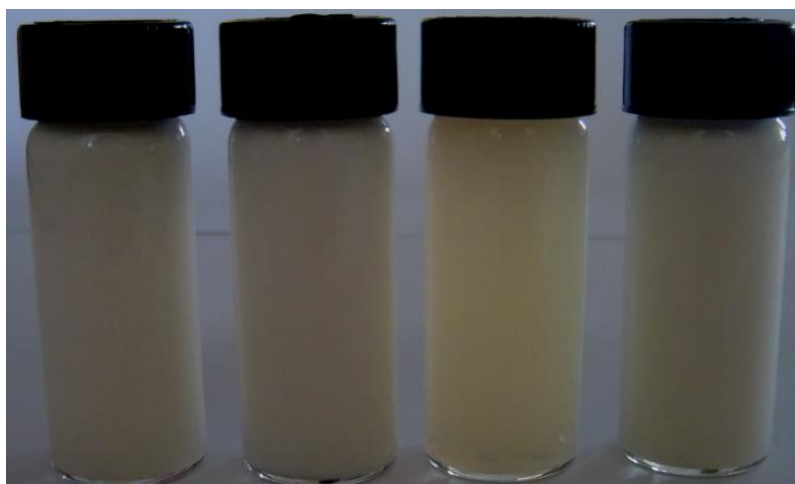
Obr. 22. Pozorování emulzí, zleva: HLB 6, 10 % emulgátoru, 1050 ot./min; HLB 6, 10 % emulgátoru, 13400 ot./min; HLB 9, 10 % emulgátoru, 13400 ot./min; HLB 9, 10 % emulgátoru, 1050 ot./min.
