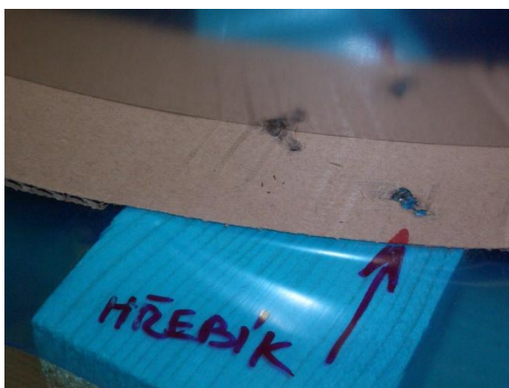
Obrázek 14: Pásek je poškozen hřebíkem (Interní materiály společnosti)
