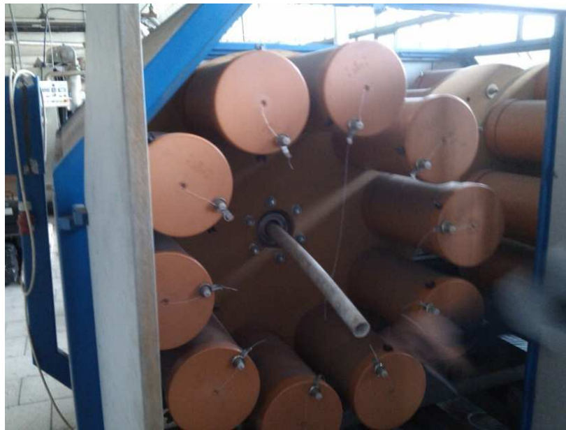
Obr. 18 Linka na navíjení polyesterových vláken (Interní, firemní informace společnosti Dl plast, s. r. o.)
