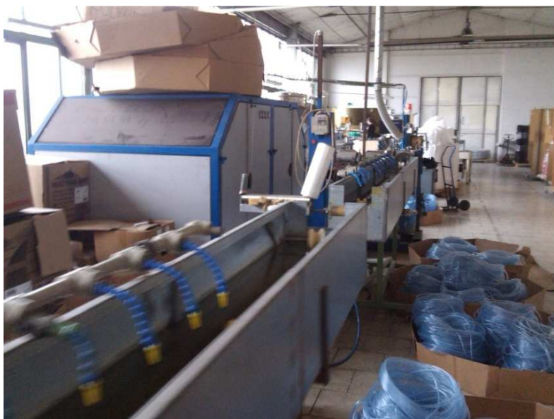
Obr. 16 Linka na výrobu hadiček bez výztuhy, zahradních a průmyslových hadic (Interní, firemní informace společnosti DI plast, s. r. o.)
