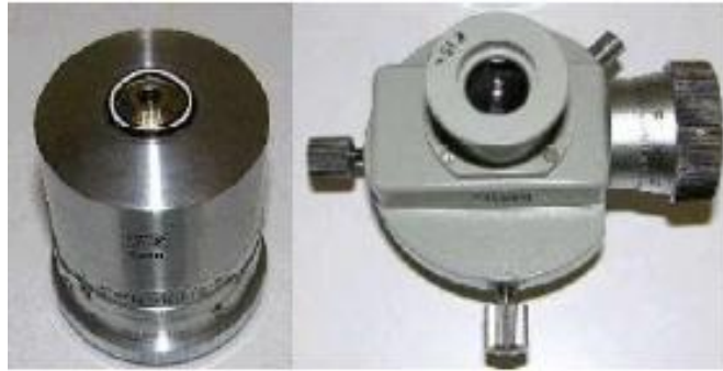
Obr. 18. Nástavec a měřící optika mikrotvrdoměru
