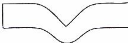
Obr.30 Zkušební těleso pro stanovení strukturální pevnosti [45]
