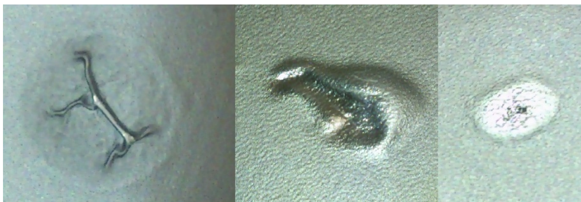
Obr. 62. Povrchové vady špatně vysušeného ABS.
