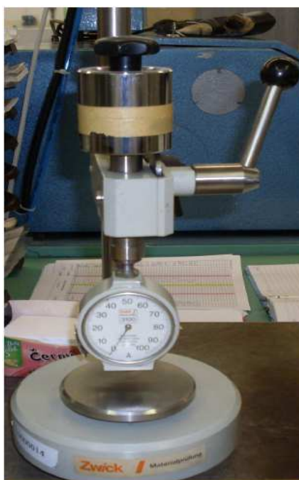
Obr. 19 Stolní tvrdoměr Zwick 3100 určený pro stanovení tvrdosti Shore A
