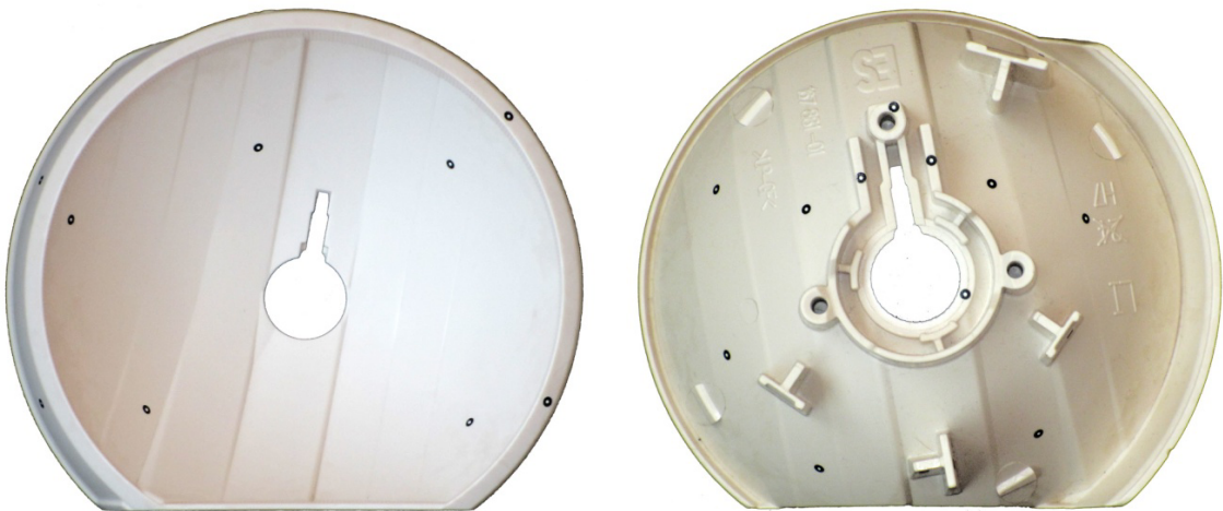
Obr. 36. Umístění jednotlivých referenčních bodů na povrchu dílu.
