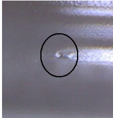
Obr. 61. Gely na povrchu PVC hadičky.
