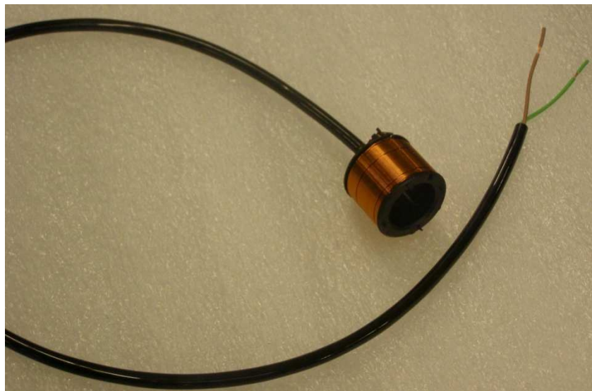
Obrázek 21: Cívka CDCe.baumraum. před zástříkem
