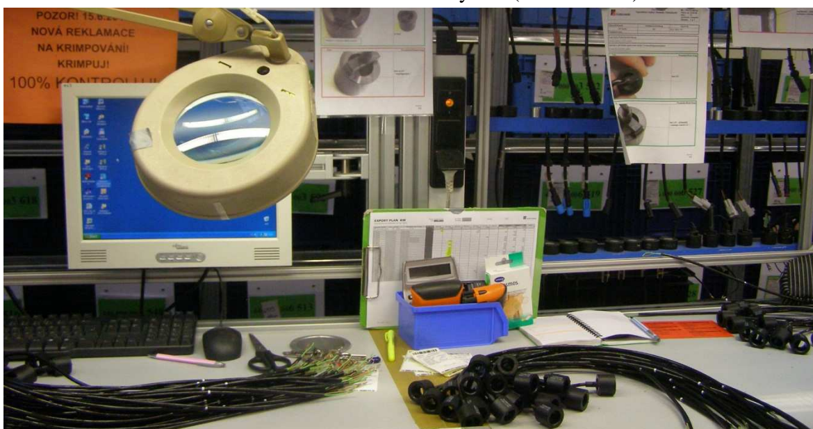
Obrázek 24: Stanoviště vizuální kontroly a kontroly délky (činnosti č. 18,19)
