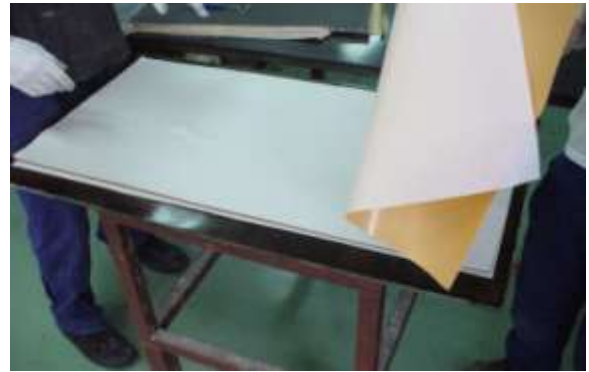
Obr. 44. Položení vrchních vrstev prepregu
