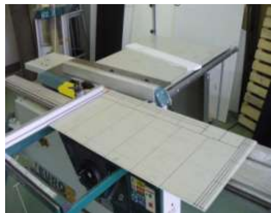
Obr. 52. Rozřezání na jednotlivá tělíska
