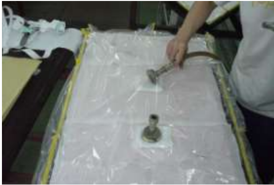
Obr. 49. Umístění odsávacích ventilů
