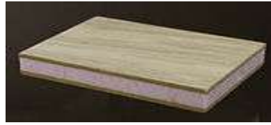
Obr. 24. Sendvič s jádrem z polystyrenové pěny [5]
