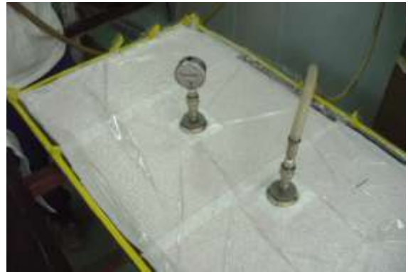
Obr. 50. Vytvoření vakua a kontrola těsnosti
