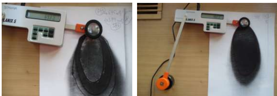
Obr. 69. Měření poškozené plochy tělíska planimetrem PLANIX 5
