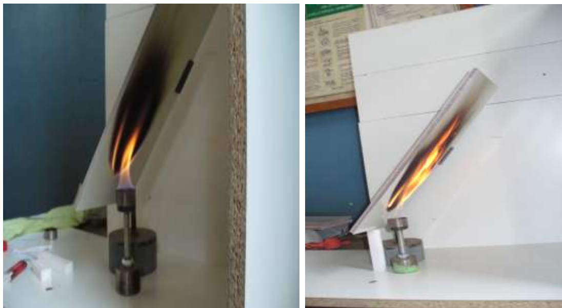
Obr. 67. Zapálení kelímku s Ethanolem a následné vzplanutí tělíska při zk. UIC
