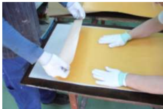
Obr. 42. Kladení vrstev prepregu
