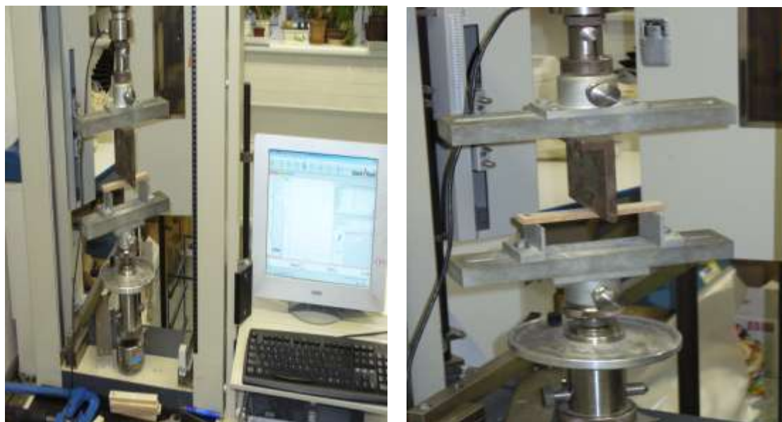
Obr. 55. Příklad ZWICK 1456 zk. OHYBU COMPOLET
