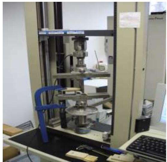
Obr. 71. Upnutí tělíska pro zk. Odlupu
