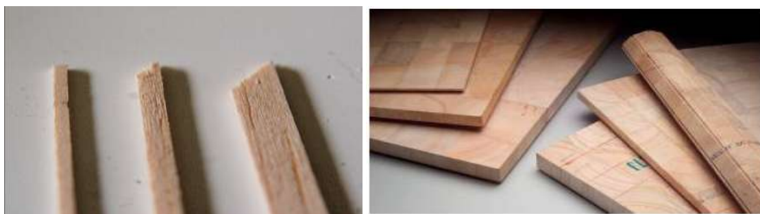
Obr. 36. Výplňový materiál balza [22]
