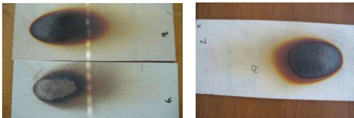
Obr. 68. Různé typy poškození zkušebních tělísek po zk. metodou UIC
